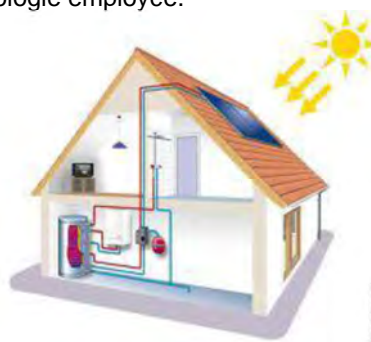
Figure 29: Schéma de principe de fonctionnement des capteurs solaires thermiques
