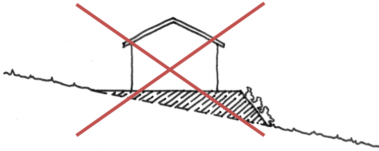
la mise à niveau par talutage
